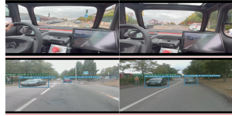
FIGURE 4 – L'algorithme testé en conditions réelles sur une Jetson embarqué
