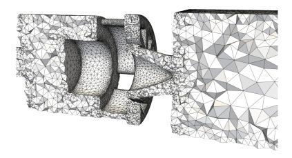
Figure 9. Final mesh of the PRECCINSTA burner.
