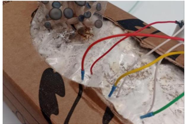
**Figure 3.** Monitoring du mycélium de la boîte à champignon au moyen de deux types d'électrodes<sup>4</sup>.
