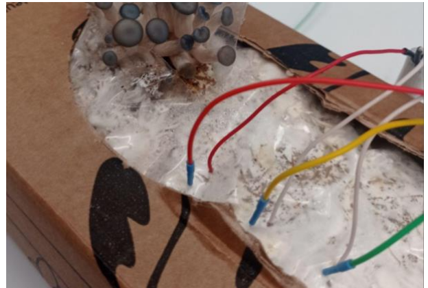
Figure 3. Monitoring du mycélium de la boîte à champignon au moyen de deux types d'électrodes 4 .
