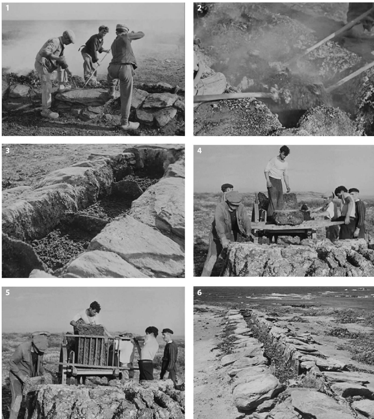
Fig. 28 – Chaîne opératoire de fabrication des pains de soude (3/3). 1, « brassage » de la soude avec des pifoun , barres de fer prolongées d'une palette ; 2, vue de détail de la soude en train de durcir formant une sorte de pâte ; 3, la soude en train de sécher dans chaque espace délimité par une pierre de chant permettra d'obtenir des pains de soude ; 4, obtention de pains de soude (entre 70-80 kg le pain) et chargement ; 5, chargement des pains de soude sur la charrette ; 6, vue du four une fois vidé de son contenu (d'après le film Goëmons de Y. Bellon, 1948).
