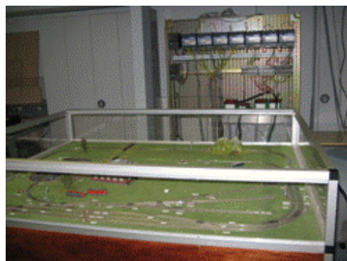
fig 1 : E/S déportées et réseau ferroviaire
