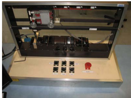
fig 3 : Partie opérative du pont transbordeur
