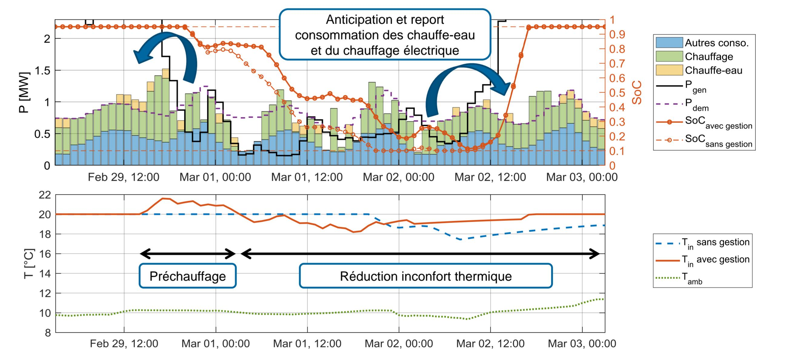
Dimensionnement considéré : PV : 1,287 MW, éoliennes : 7,29 MW, hydroliennes : 1,2 MW, houlogénérateurs : 0,58 MW, batteries : 14,17 MWh
