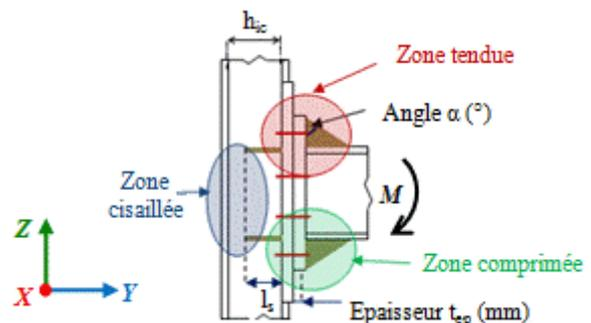
**Figure 8 :** Détails des paramètres à varier
