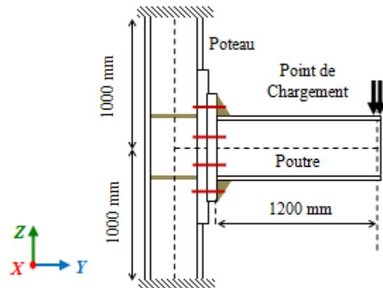
Figure 3 : Conditions aux limites et de chargement
