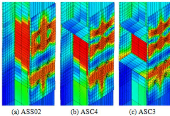
Figure 15 : Influence des raidisseurs sur la distribution de contraintes de von Mises
