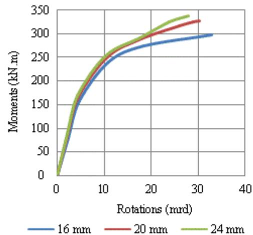
Figure 10 : Etude paramétrique - épaisseur de la platine
