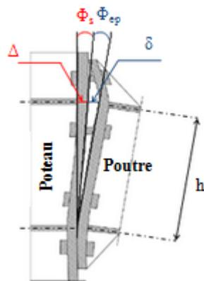
Figure 5 : Rotation dans un assemblage boulonné
