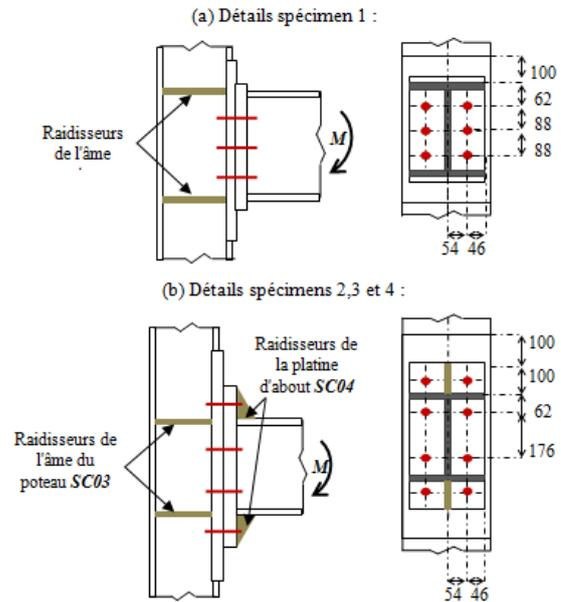
Figure 1 : Détails géométriques des spécimens étudiés
