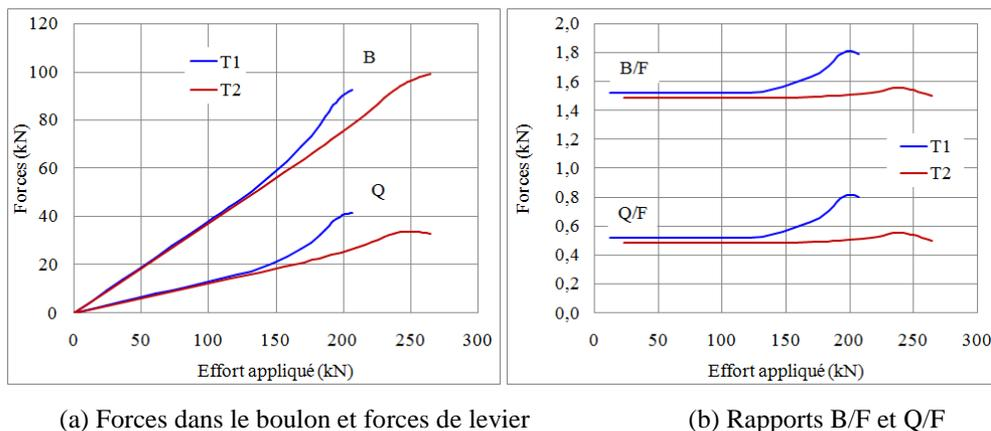
(a) Forces dans le boulon et forces de levier
