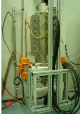
Figure 6: Photographie de l'installation de CVD en lit vibro fluidisé du LGC ; (b) Vue par MEB des dépôts de silicium sur les grains de \text{TiO}_2
