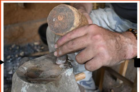
Découpage d'une « **idole en forme d'anneau** » en argent à partir d'un brut de coulée, entrecoupé de 5 phases de recuits. Mise en forme par abrasion, polissage et perforation de l'attache à l'archet. Durée totale : 2 heures 30.
