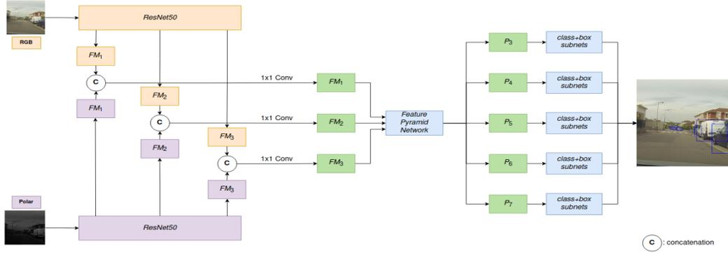
FIGURE 2 – Schéma de la fusion multimodale centrale proposée
