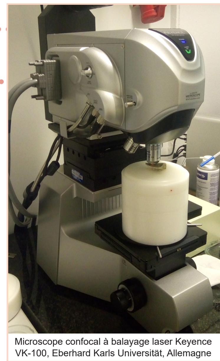
Microscope confocal à balayage laser Keyence VK-100, Eberhard Karls Universität, Allemagne
