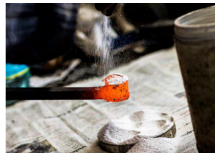
Fig.401 : Application d'une poudre de borax sur du métal à température de forge (photographie : Christophe Mely, studiomely.com).
