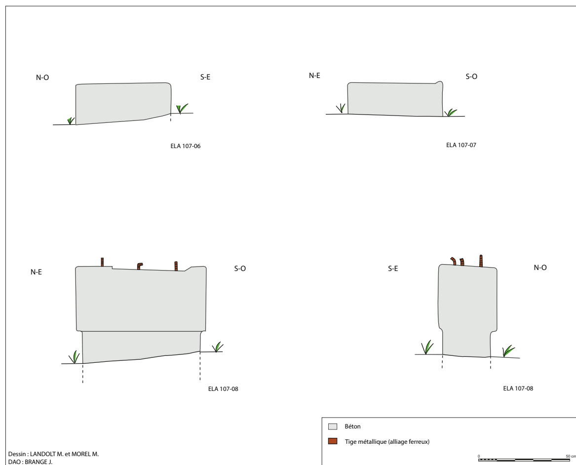
Figure 113 : Profils des bases d'enclumes en béton (J. Brangé).
