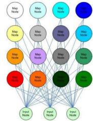
La structure présentée ici est un réseau de 4 par 4, soit 16 nœuds, chacun d'entre eux est relié à chacun des 3 nœuds d'input. Pour cette carte on a donc 16x3 = 48 connections.
