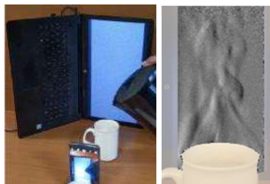
Figure 5 : Mesure de la convection naturelle au-dessus d'une tasse d'eau chaude avec la méthode BOS et un smartphone. Gauche : montage expérimental. Droite : Cartographie de déplacements horizontaux, sur une échelle de -0.15 px (noir) à +0.15 px (blanc)
