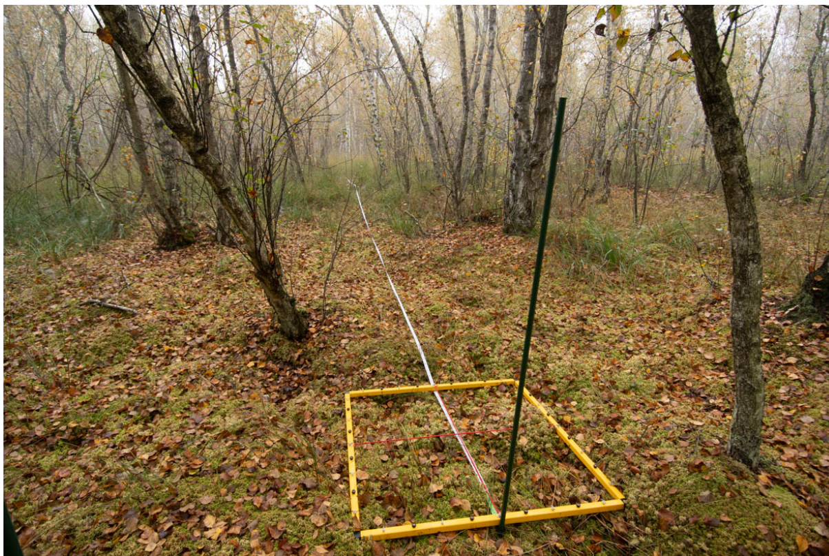
Figure 9 : Implantation du suivi de la placette 1 : repère fixe, cadre de suivi, décimètre matérialisant le transect.
