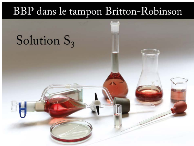
Figure 24 - Image de la solution S_3 contenue dans plusieurs ustensiles de verrerie utilisés en chimie. De gauche à droite et de bas en haut : boîte de Pétri, ampoule de coulée, cuve rectangulaire en verre, cuve en plastique de 1 cm d'épaisseur, fiole jaugée, pipette Pasteur, erlenmeyer et bécher.
