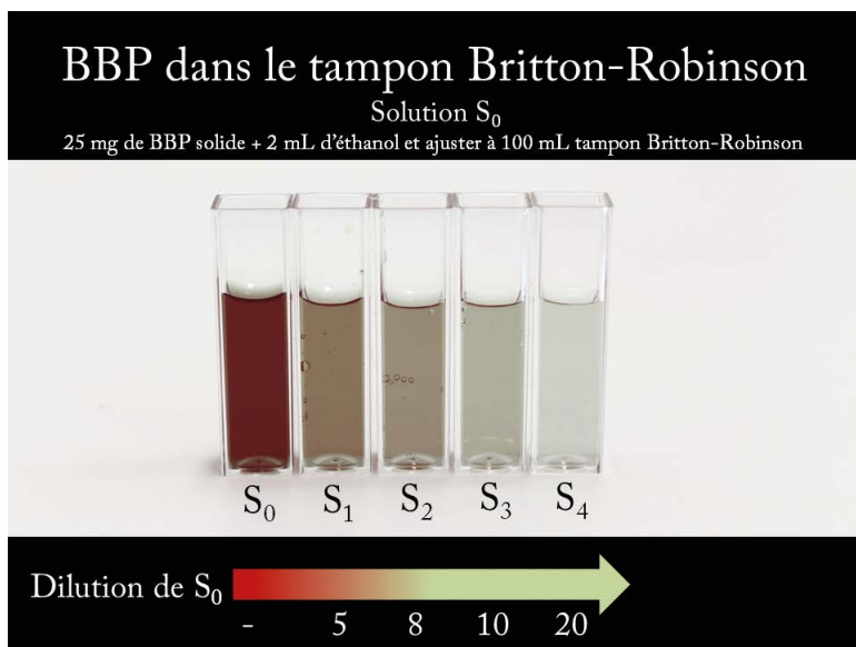
Figure 18 - Image de cuves contenant les solutions S_0 à S_4 de BBP dans le tampon Britton-Robinson.
