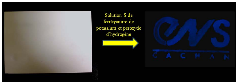
Figure 10 - Révélation par une réaction de chimiluminescence (vaporisation d'une solution de ferricyanure de potassium et peroxyde d'hydrogène) d'un message écrit avec du luminol.
