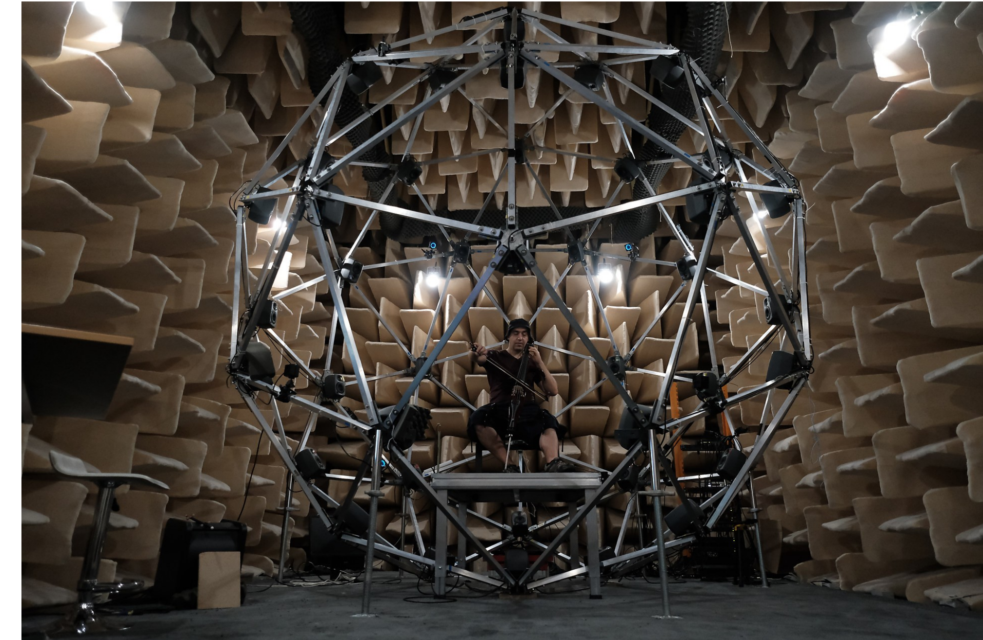
Sphère de 42 enceintes Genelec 8020C au laboratoire PRISM
