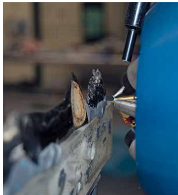
(Fig. 10) — Détail de la tête de la sonde nucléaire A.G.L.A.E. qui permet, avec la méthode PIXE, une caractérisation spectroscopique des éléments chimiques composant le matériau à analyser par excitation de la surface de la matière sans la détruire. Cette méthode envoie des faisceaux d'ions (radiations de particules chargées) pour exciter le matériau qui émet un rayonnement (rayons X).
