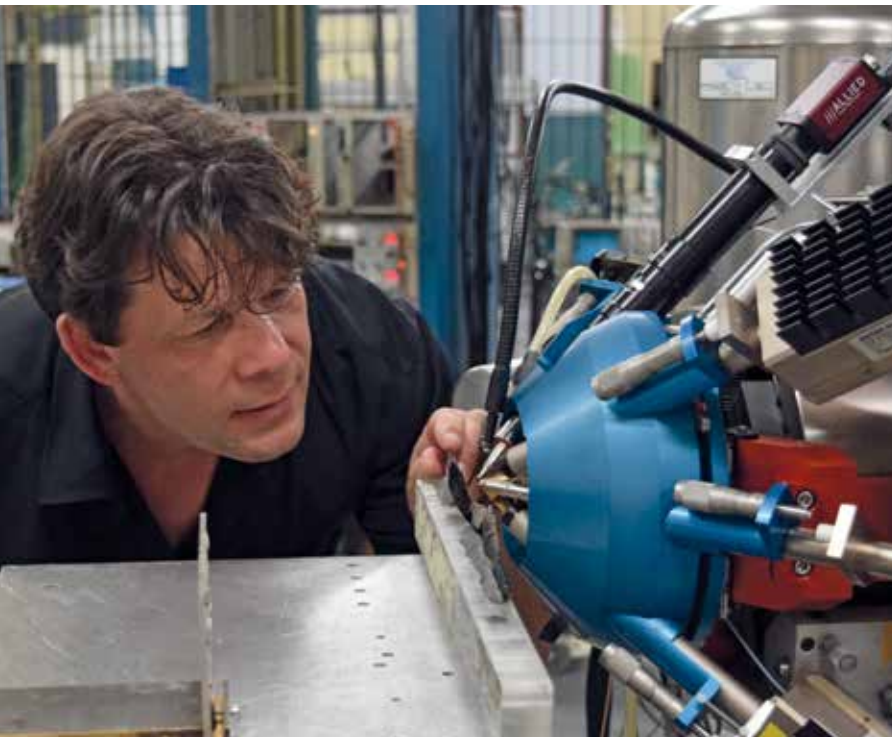
(Fig. 9) — Obsidiennes archéologiques positionnées pour être analysées avec la sonde nucléaire A.G.L.A.E. du Centre de Recherche et de Restauration des Musées de France (C2RMF) installée au Palais du Louvre (Paris, France). Cette sonde emploie la méthode PIXE ( Particle Induced X-ray Emission ) qui est une technique non-invasive qui consiste à analyser par spectroscopie les rayons X émis lors de l'excitation de la surface de la matière à analyser par des particules chargées (ions).
