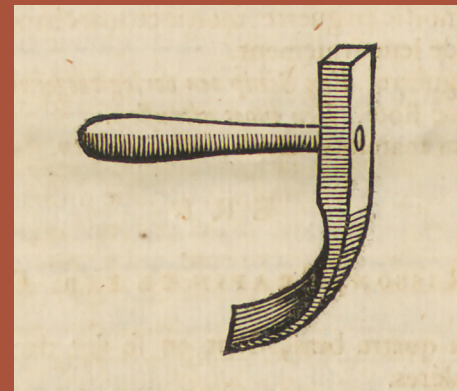
Deux herminettes utilisées pour tailler la quille, d'après Aubin, p. 434, fig. 3 (herminette).
