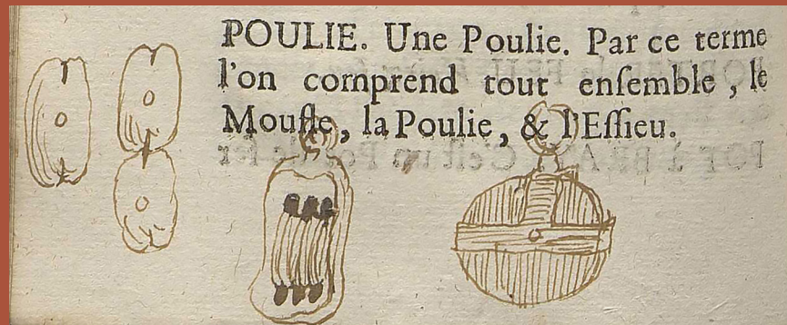
Diverses sortes de poulies, d'après Desroches, 1687, p. 426 (croquis de Nicolas d'Angerville d'Auvrecher, vers 1757).
