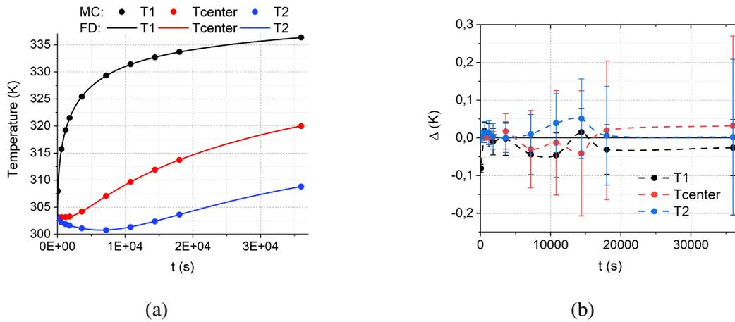
Figure 4 : Température au-dessus, à l'intérieur et sous une dalle de béton homogène calculée avec une méthode des différences finies et une méthode MC pour un  $\varphi = 900 \text{ W.m}^{-2}$  (a) et la différence de température  $\Delta$  entre les deux méthodes (b).
