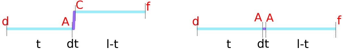
FIGURE 7 – Chemins élémentaires pour compter le nombre de transitions de A vers C (gauche), et le temps passé dans l'état A (droite).
