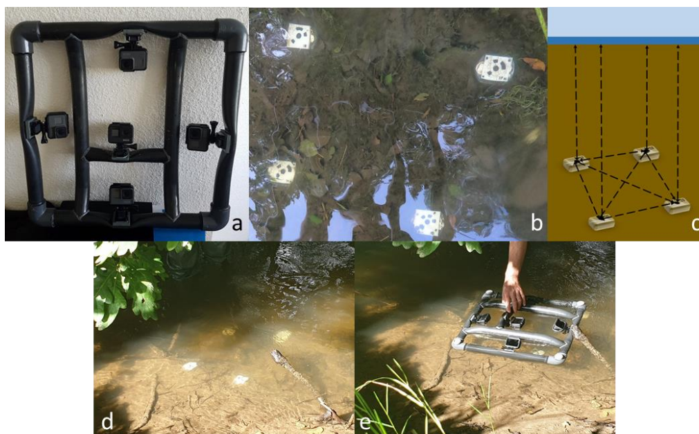
Figure 2 : a) Photo du dispositif de prises de vues ; b) Photo émergée des quatre cibles permettant de délimiter le patch (Rivière Oir3, patch n°2, en 2021) ; c) Schéma des mesures prises de la profondeur de chaque cible et des distances entre chaque cible et des distances entre chaque cible (lignes discontinues) ; d et e) Positionnement des cibles in situ et déploiement du dispositif sur une banquette (Rivière Oir).
