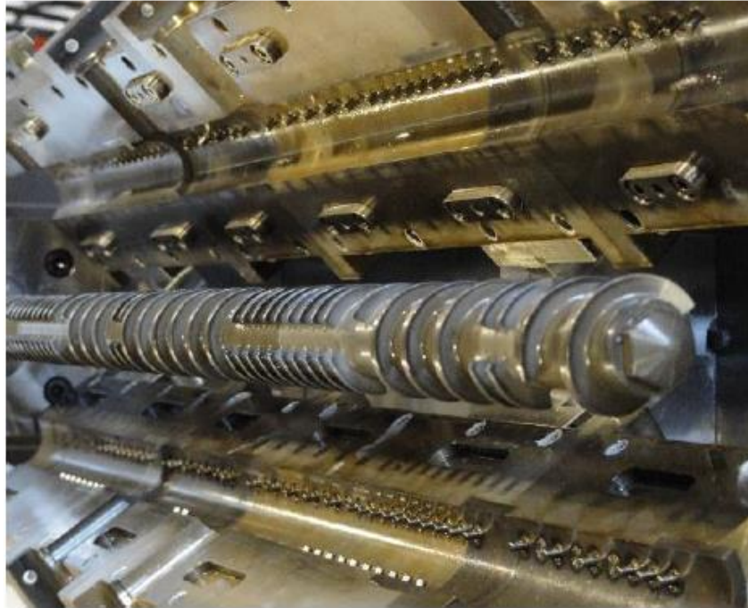
Figure 2 - Co-malaxeur ouvert, montrant la vis avec les interruptions de filet et les doigts de malaxage fixés sur le fourreau [1]
