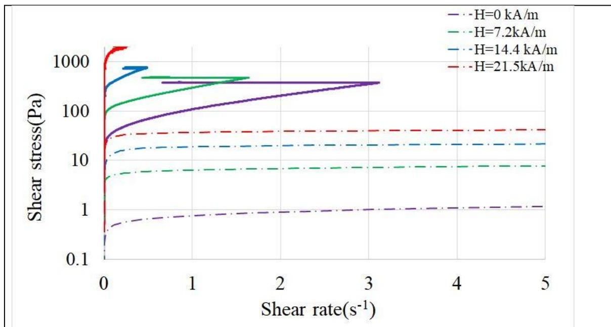
Figure 1. **Ligne pointillé** : Particules de fer  $\Phi=0.23$  **Trait plein** : Particules de fer  $\Phi=0.23$  plus des particules de CaCO<sub>3</sub> avec une fraction volumique totale de solide :  $\Phi=0.74$
