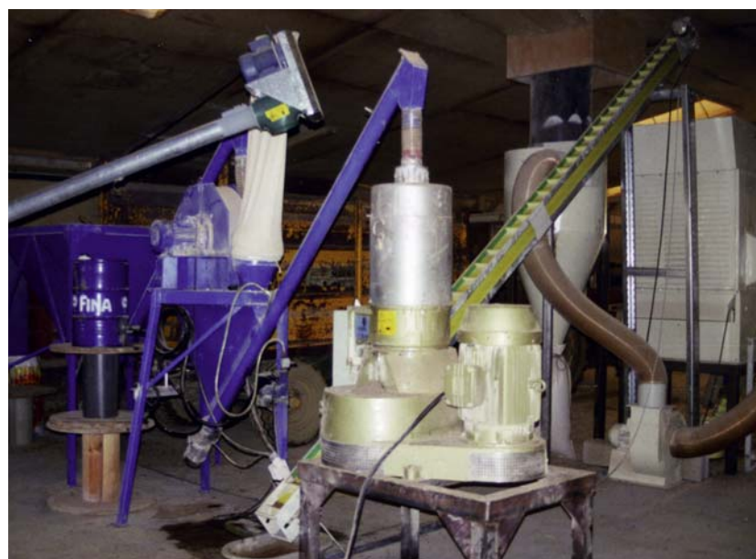
Fig.8.10: Installation de granulation de fientes de poules pondeuses.
