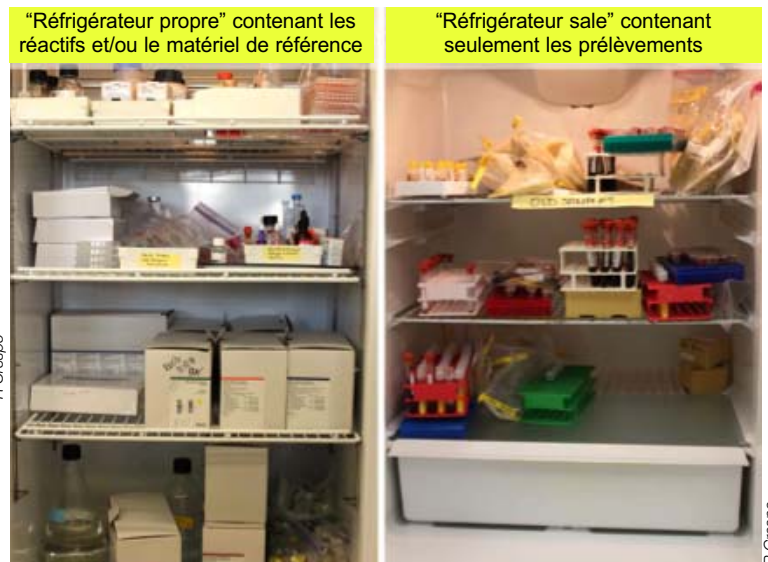
Fig.17.15: La contamination croisée des réactifs et des produits à contrôler sera évitée en maintenant ces différents produits dans des espaces de rangement différents.
