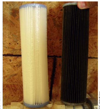
Fig.81.32: Filtre nettoyé et filtre obstrué par des dépôts de fer et de manganèse.
