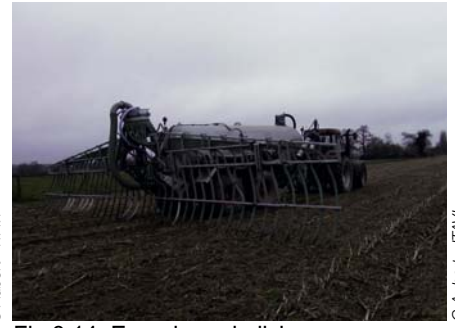
Fig.8.14: Épandage de lisier avec un système à pendillards.
