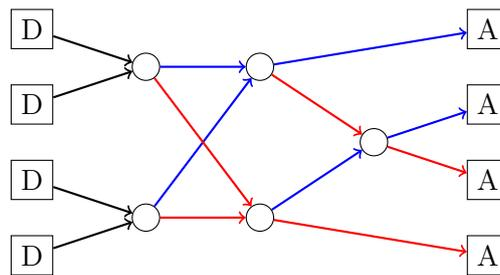
FIGURE 4 – Réseau de tri optimal à quatre éléments
