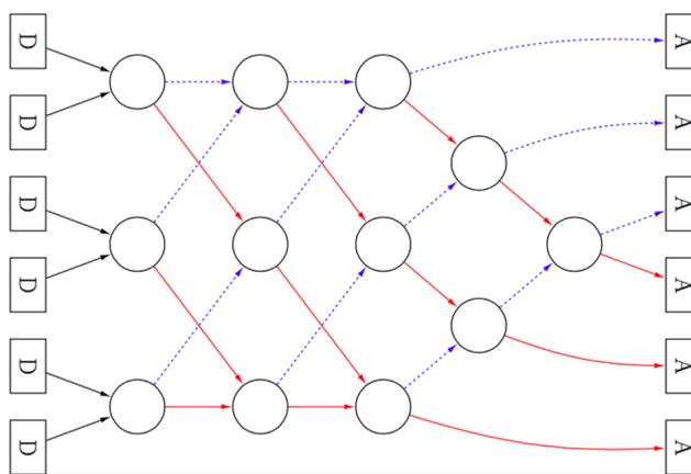
FIGURE 3 – Réseau de tri à six éléments
