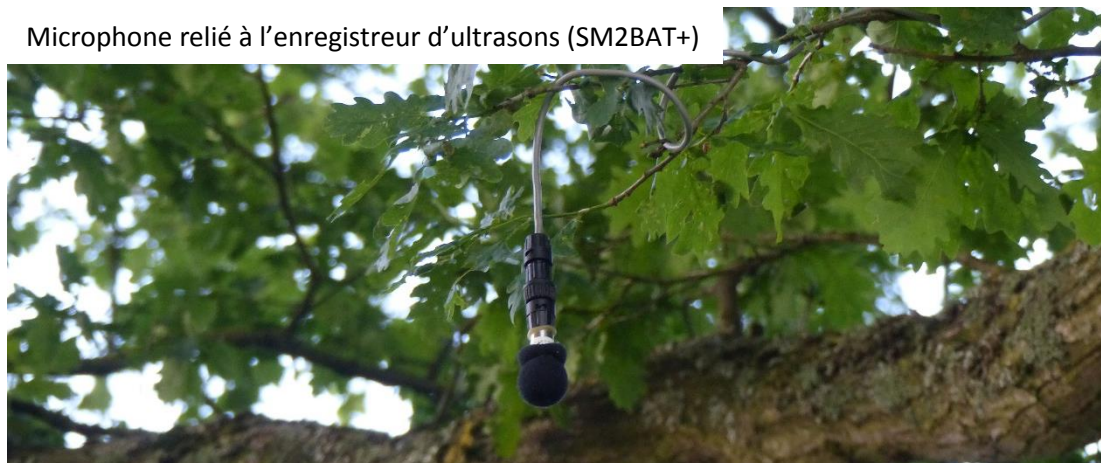
Détecteur et enregistreur d'ultrasons (SM2BAT+)
