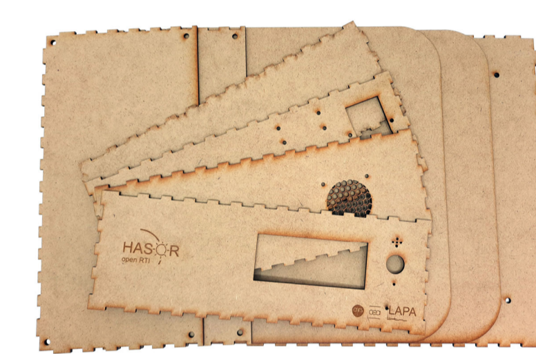
Dessin vectoriel destiné à la découpe laser, panneaux découpés et boîtier assemblé
