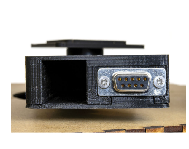
Fourche mobile et sa connectique femelle
