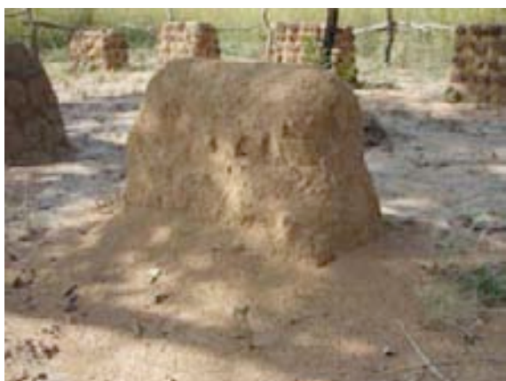
Muret témoins utilisant la carrière C2 sans préparation préalable et sans ajout de stabilisant naturel
