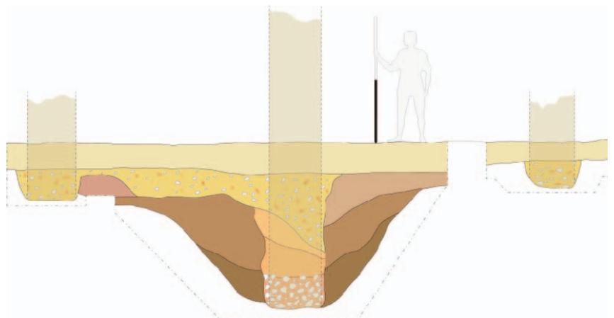
Coupe simplifiée et restitution des structures maçonnées au niveau de la clôture orientale du sanctuaire de Juvigné. Au centre, les fondations du péribole installées dans le comblement d'un fossé antérieur aux dimensions imposantes; de part et d'autre, deux galeries, délimitées par des murs aux fondations moins profondes.
