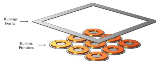
Figure 3: Proposition d'amélioration du dispositif avec bobine de forme carré et lisière de ferrite sur la table au secondaire
