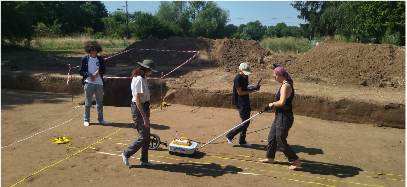
Fig.19 Réalisation de prospection géoradar en cours de fouille (Photo Ch. Sanchez)
