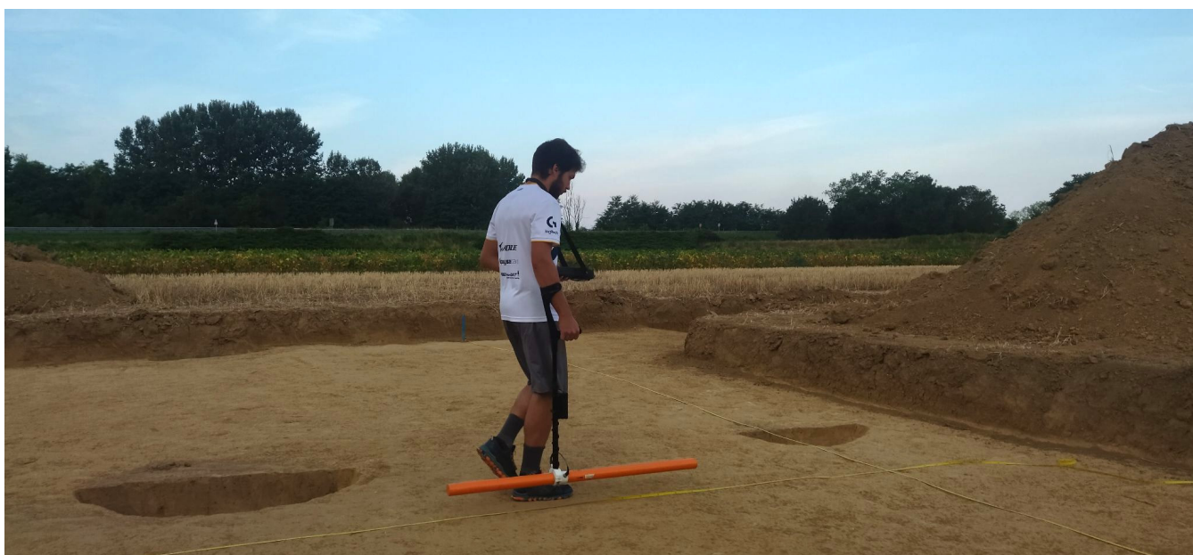
Fig.17 Réalisation de mesures électromagnétiques en cours de fouille (Photo C. Sanchez)
