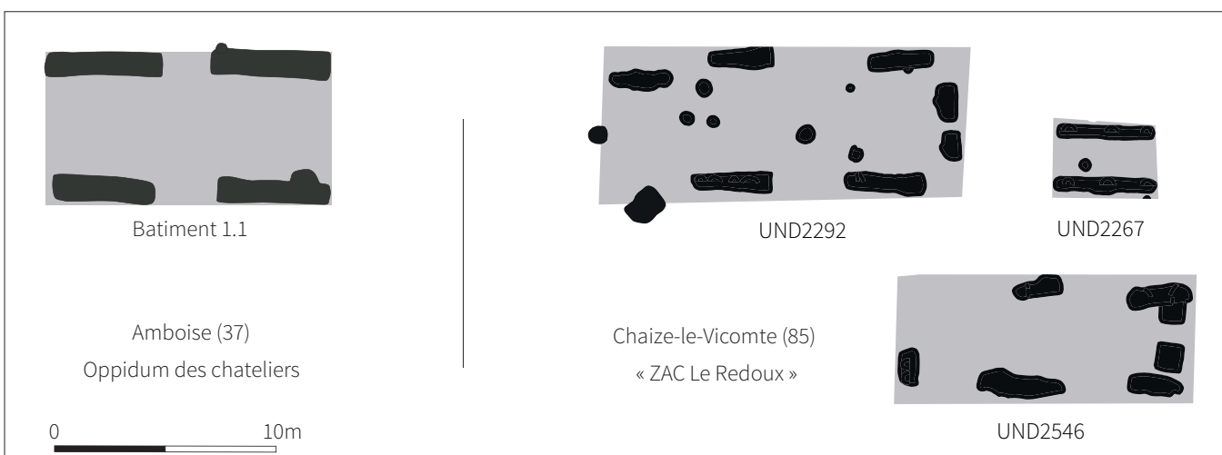
Fig.53 Quelques exemples de bâtiments fondés sur tranchées de fondation massives, issus de fouilles récentes. (D'après Laruaz 2018 et Cure 2019))
