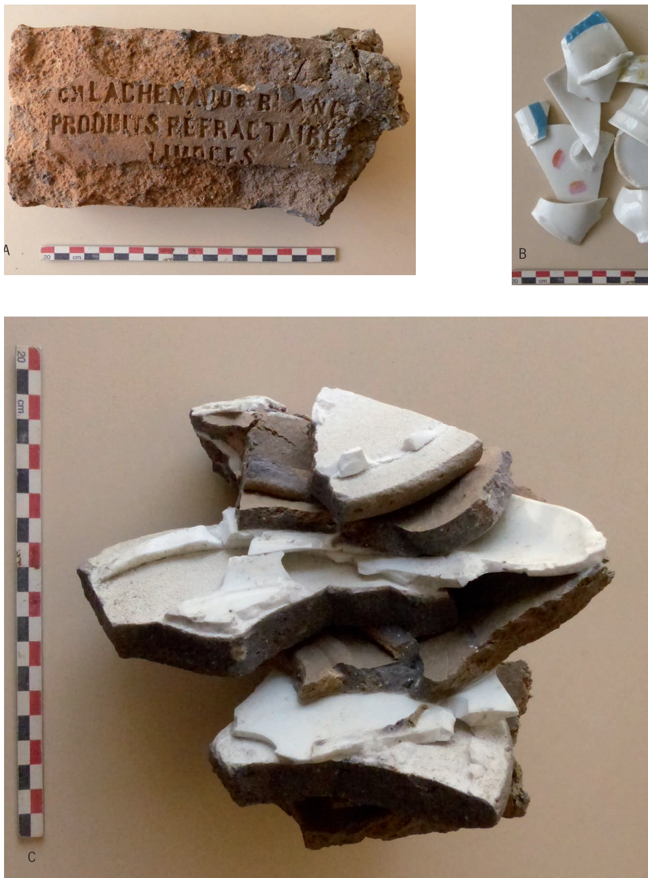
Fig.71 Éléments divers : A : Brique réfractaire de four avec marque de son fabricant ; B : Essais de couleurs sur pièces blanches ; C : Mouton de raté de cuisson (surchauffe du four). DAO F. Devevey, clichés F. Chevreuse, Inrap
