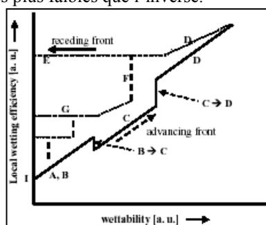
Figure 2 : Evolution de  $f_w$  avec la mouillabilité
