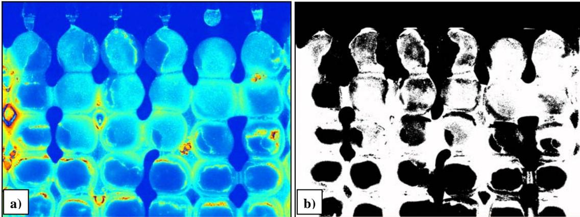
Figure 5 : Images brutes de l'écoulement a) et image de l'écoulement binarisée b)
