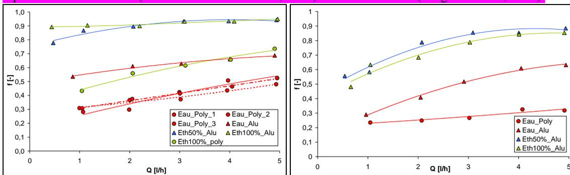
Figure 8 : Evolution de  $f_w$  avec le débit au sommet a) et au centre b) de la plaque
