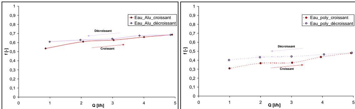
Figure 9 : Phénomène d'hystérésis pour les systèmes Eau-Alumine a) Eau-Polypropylène b)
