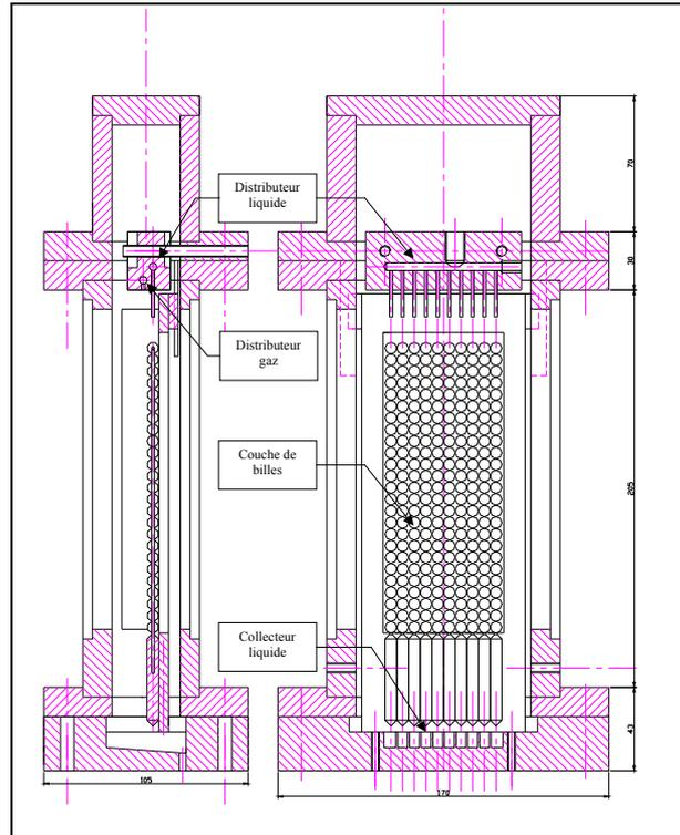
Figure 3 : Schéma de la maquette bidimensionnelle
