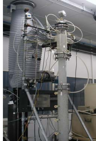
Figure 1 : Dispositif expérimental : 1 : colonne en verre de 8,3 cm de diamètre et de 2 m de haut, 2 : circuit de refroidissement, 3 : distributeur de gaz, 4 : sonde oxymétrique Unisense, 5 : bisonde résistive, 6 : interface d'acquisition, 7 : enregistrement des résultats, 8 : débitmètre, V1 : vanne d'entrée d'azote, V2 : vanne d'entrée d'air.
