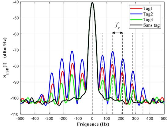
**Figure 3. Mesure de la densité spectrale de puissance rétrodiffusée pour les 3 tags tournant à  $f_r = 70$  Hz pour une fréquence porteuse  $f_0$  de 1,75 GHz. La mesure « Sans tag » correspond à la DSP de la chambre lorsqu’aucun objet ne tourne.**
