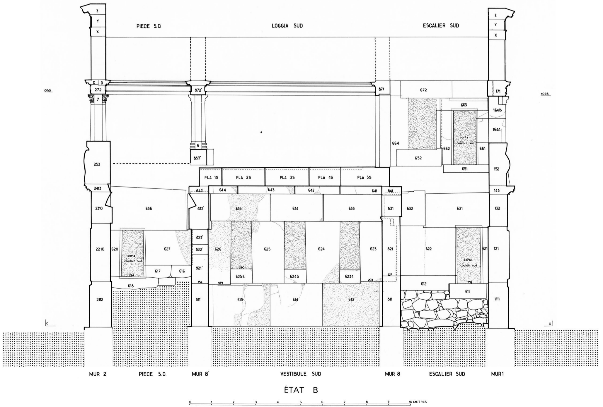
33. Mur 6, face sud: vestibule sud, pièce d'angle sud-ouest et escalier sud (états A et B).
