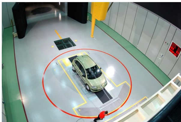
Figure 5 – Soufflerie du GIE S2A. Véhicule positionné sur le plateau d'expérimentation. Le véhicule peut tourner autour de la verticale.
