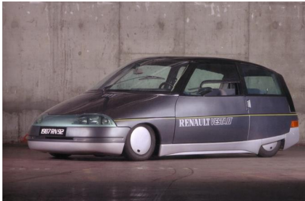
Figure 2 - Prototype VESTA II (Véhicule Économe de Systèmes & Technologies Avancées), 1987. C_x=0.186 . Crédit Renault.
