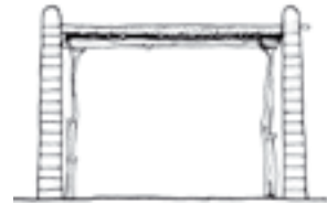
toiture terrasse traditionnelle La terrasse repose sur des supports en bois
