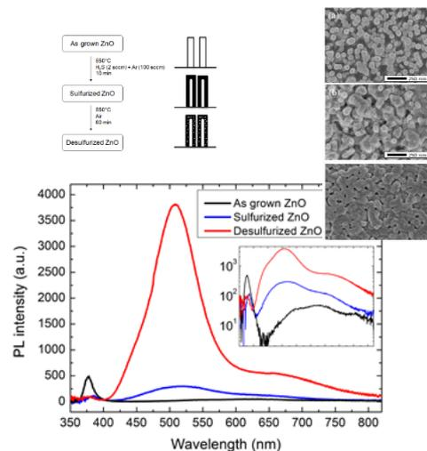
Fig. 1. a) Recyclabilité de la technologie actuelle : illustration d'une lampe LED E27 fragmentée sélectivement b) écoconception à base d'un matériau unique abondant : émission de lumière blanche sans terre rare par sulférisation et désulfurisation de nanofils de ZnO.
