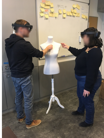
FIG. 1. Co-création en Réalité Augmentée. Gabrielle et Karl, deux concepteurs de vêtements, utilisent des casques de RA pour réaliser un modèle 3D virtuel de veste basé sur un mannequin de couture physique.
