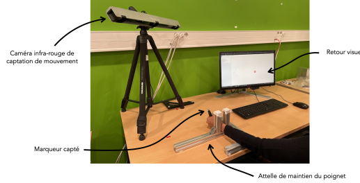
FIG. 3. Appareillage utilisé pour l'étude. La main des participants est maintenue dans une attelle. Cette main tient un feutre avec un marqueur, qui est capté par une caméra infrarouge. Le marqueur contrôle un curseur visualisé sur l'écran.
