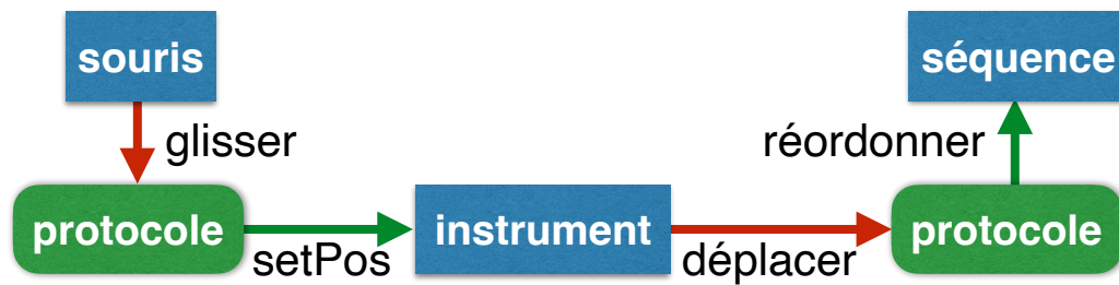
FIG. 4. L'instrument de déplacement reçoit l'action glisser de la souris, qui met à jour sa position, et émet une action déplacer qui est interprétée par la séquence comme un réordonnement de l'élément déplacé.
