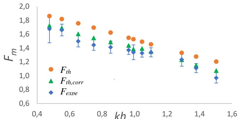
Figure 2 : Amplitude moyenne de la force appliquée à la digue mesurée expérimentalement  $F_{exp}$  comparée avec les résultats théoriques. Le coefficient de réflexion est égal à 1 pour  $F_{th}$ . Pour  $F_{th,corr}$  on utilise le coefficient de réflexion mesuré expérimentalement. Ces résultats sont obtenus sans flotteur.  $k$  représente le nombre d'onde de la houle
