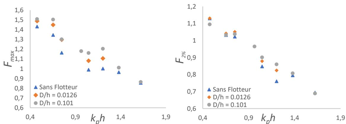
Figure 4 : a) Efforts maximums subits par la digue pour une houle irrégulière. b) Moyenne des 2% plus importantes valeurs d'effort enregistrées. Le nombre d'onde à la fréquence pic est noté  $k_p$ . Les paramètres sont les suivants :  $a/h = 0.05$ ,  $\Gamma/h = 0.165$ ,  $L/h = 0.126$ .
