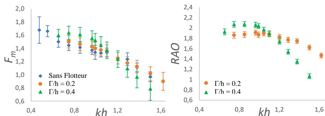
Figure 3 : a) Comparaison des efforts subits par la digue avec et sans flotteur. La houle est régulière. b) RAO correspondante aux mesures d'effort. Les paramètres sont les suivants :  $a/h = 0.05$ ,  $D/h = 0.02$ ,  $L/h = 0.6$ .
